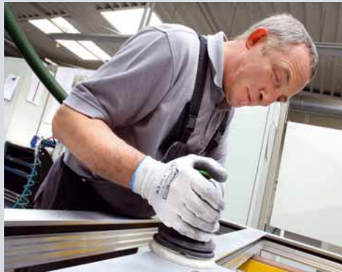
In sechs aufwändigen Arbeitsgängen wird eine absolut glatte Oberfläche erzeugt
