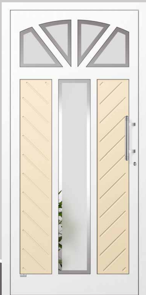
T 515 verschweißt , RAL 9016 weiß matt / RAL 1015 hellelfenbein matt, Glas Float gestrahlt mit umlaufend klarem Rand, Paneel Alu gefräst, Griff 1935 Edelstahl
