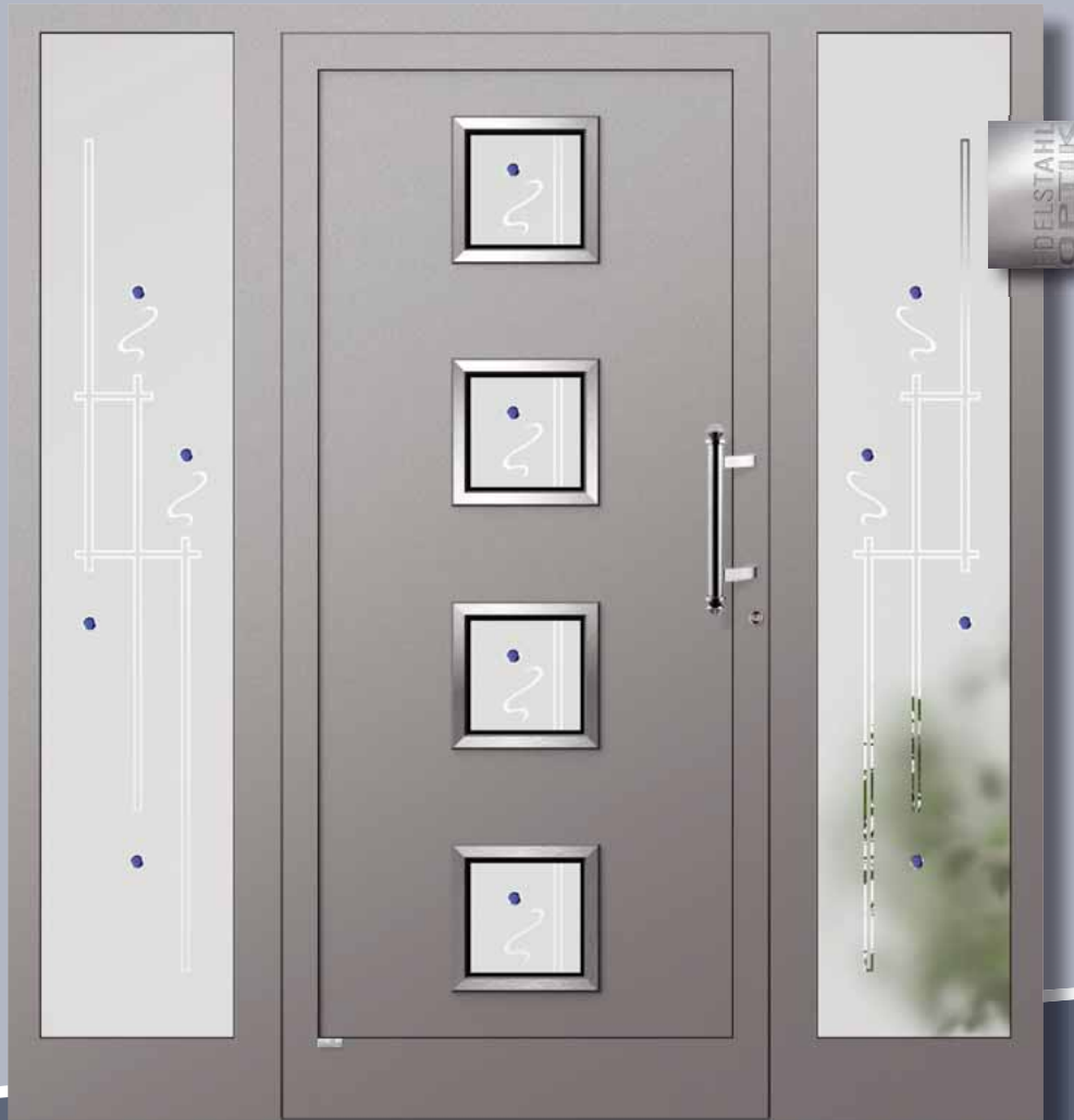
S 1019 eingesetzt , RAL 9007 graualuminium / Edelstahl-Optik Glas 1T002 (Float teilmattiert mit Applikationen), Griff 1781 Edelstahl
