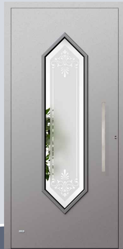
S 1515 außen aufgesetzt , RAL 9006 weißaluminium matt / RAL 7046 telegrau 2 matt, Glas 1Go22 (Float teilmattiert), Griff 1768 Edelstahl 600 mm
