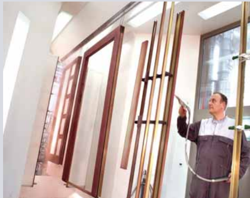
Nach Tauchvorbehandlung Beschichtung in der hauseigenen Anlage
