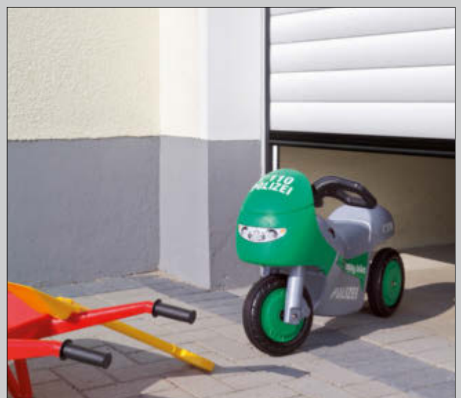
Die Abschaltautomatik stoppt das Tor bei Hindernissen
