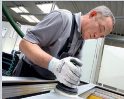
In sechs aufwändigen Arbeitsschritten wird eine absolut glatte Oberfläche erzeugt
