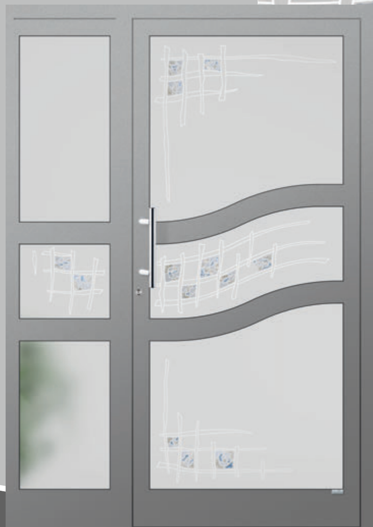
T 114 verschweiß , RAL 9007 graualuminium, Glas TT103 (Float teilmattiert mit farbigen Prismen), Griff 1791 Edelstahl
