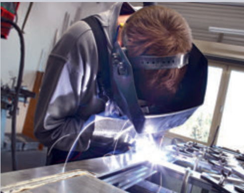
Verschweißte Rahmen- und Flügel- konstruktion
