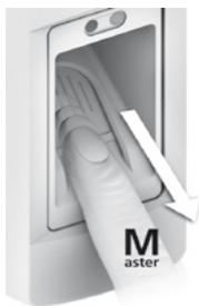
1. Kanal 1: Finger langsam über Scanner ziehen (1. mal)
