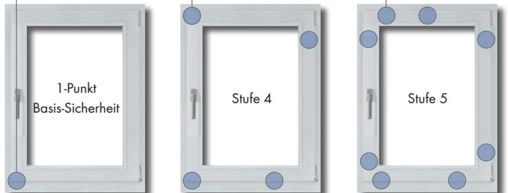
Effektiver Systemaufbau bei generellem Einsatz des Komfortpilzbolzens als Verschlussbolzen, nur wenige Verlängerungsbauteile sind nötig, um aus einem Grundsicherheitsfenster jedes beliebige Stufe 4- oder Stufe 5-Fenster zu bauen.
