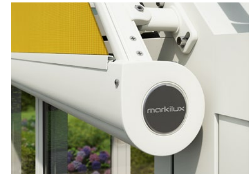
MX_893 Runde Tuchkassette, Ø 115 mm, mit Bürstendichtung am Tuchaustritt.
